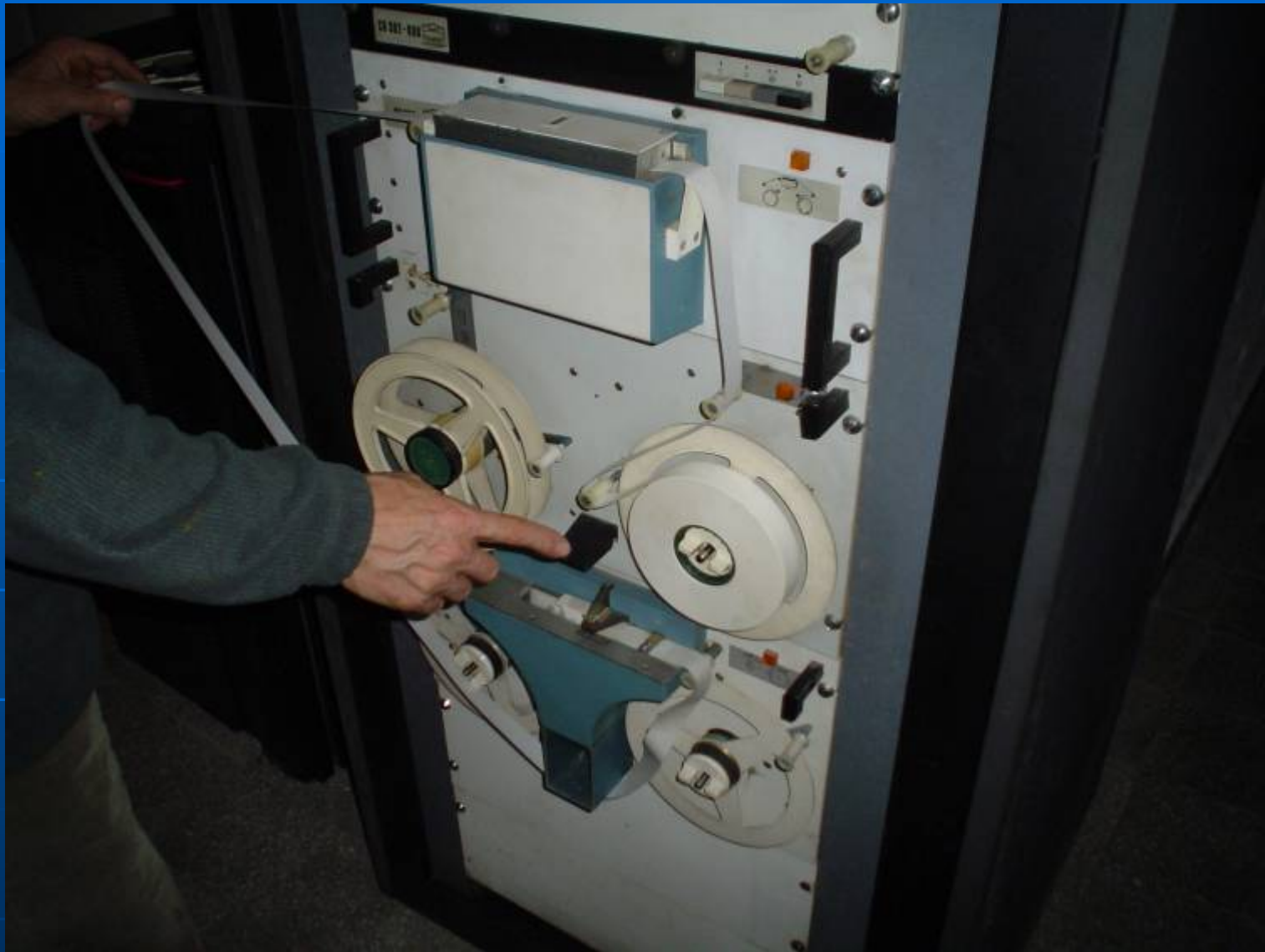
Az R-10 lyukszalag-állomása: olvasó- és lyukasztóegység
