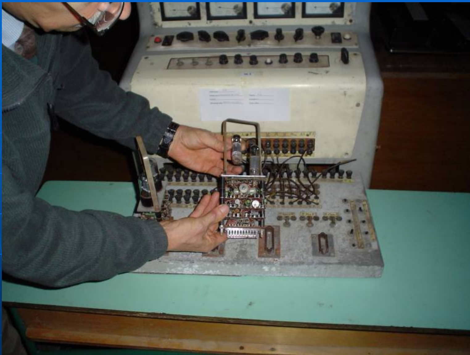
Egy M-3 elektroncsöves alegység vizsgálata
