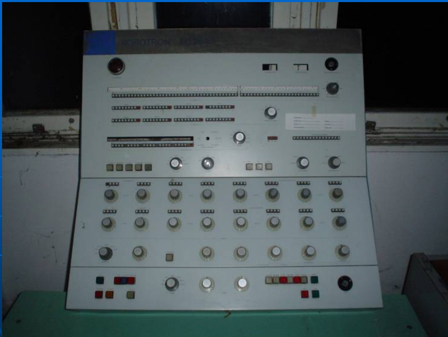
Az R-40 mérnöki és programozói vezérlőpultja (hexakapcsolók és mikrogépállapot jelzők)
